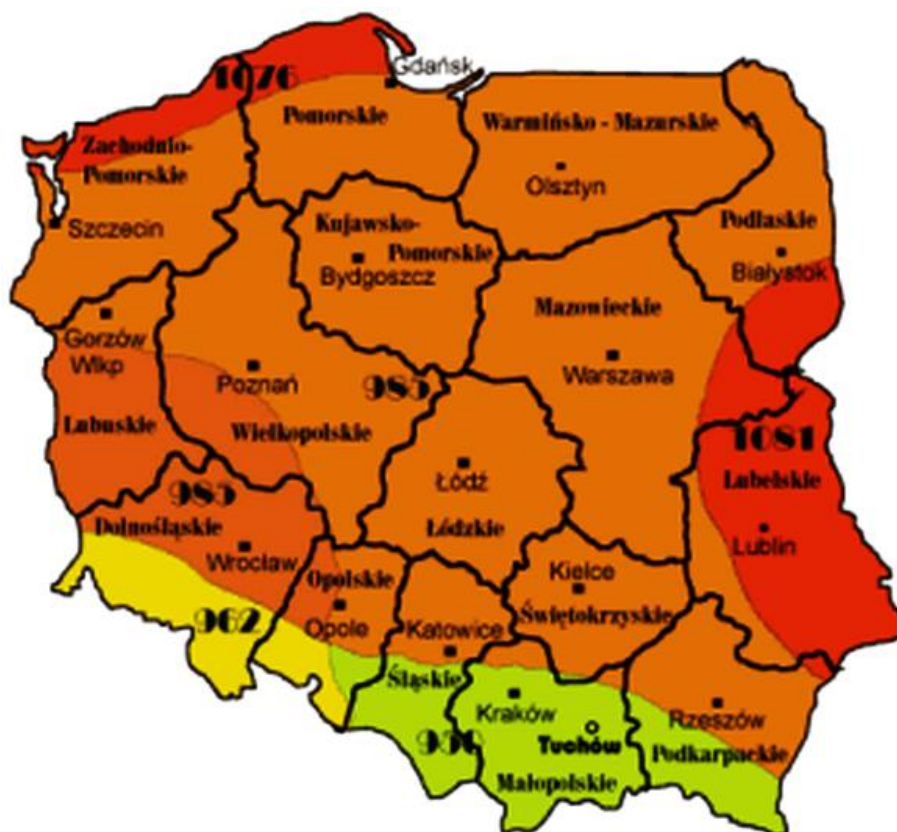
Rysunek 7. Rejonizacja średniorocznych sum promieniowania słonecznego całkowitego padającego na jednostkę powierzchni poziomej [kWh/m 2 /rok]
