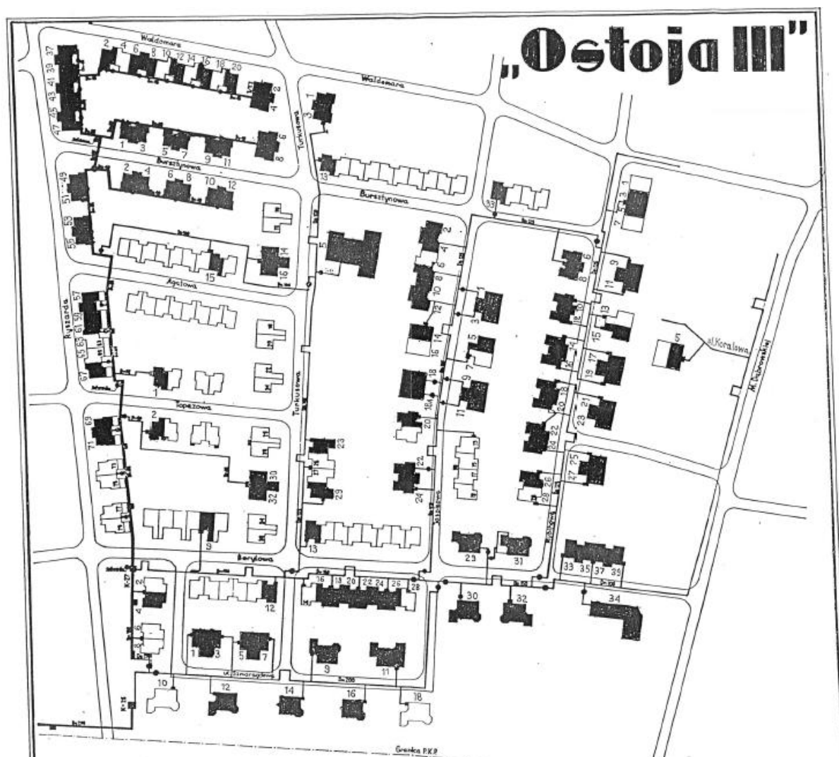
Rysunek 12 Schemat sieci ciepłowniczej na terenie osiedla Ostoja III w Gminie Michałowice [Źródło: dane PGNiG TERMIKA S.A.].
